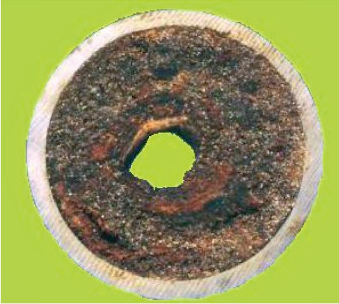
Fig. 1. – Sezione di condotta ostruita da un deposito di cera.
