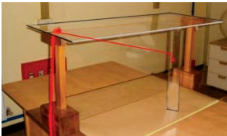
Fig. 2. – Prospettimetro e supporto verticale al quale è stato fissato un filo che coglie il punto A e che simula il raggio visivo uscente dall'occhio posto nella posizione del chiodo al quale è legato il capo fisso del filo.
