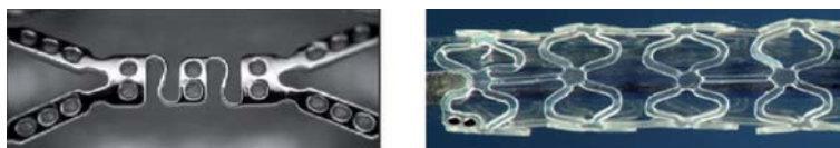
Fig. 4. – Due diverse tipologie di stent: a sinistra stent tipo pozzetto in cui i fori sono riempiti con farmaco (Conor Medsystems, Menlo Park, California); a destra uno stent completamente degradabile (Abbott Laboratories, IL, USA).
