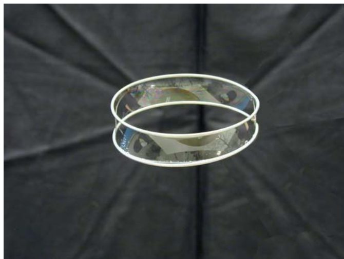
Fig. 4. – Lamina a forma di catenoide.
